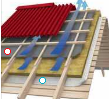
Крыша с двуконтурной вентиляцией
