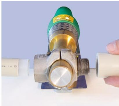
⑦ Після маркування зварювані поверхні необхідно очистити і знежирити. Без знежирення з'єднання розплавлених поверхонь може бути не дуже якісним! Після цього можна приступити до процесу нагрівання.
